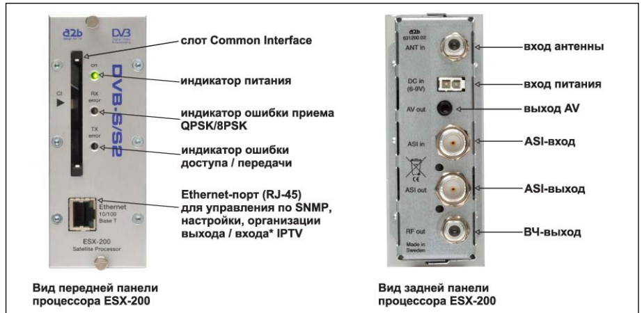
Рис. 6. Разъемы (интерфейсы) и индикаторы.
