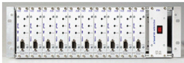
Installation i basenhet med 10 moduler och en gemensam nätdel.
