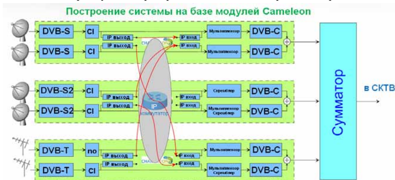
Рисунок 1. Пример структурной схемы построения системы на базе модулей Chameleon с IP коммутацией.
